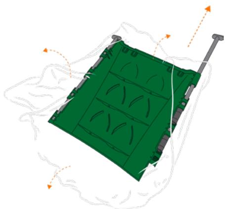
**2** Poser les panneaux sur une surface plane et les unir en insérant les tiges.
